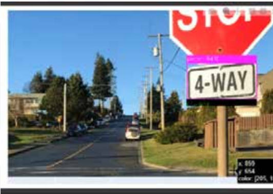
Fig. 7. Detección de una señal de tránsito como una placa vehicular (Elaboración propia).
