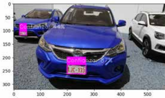
Fig. 6. ROI generadas por el modelo de detección de placas (Elaboración propia).
